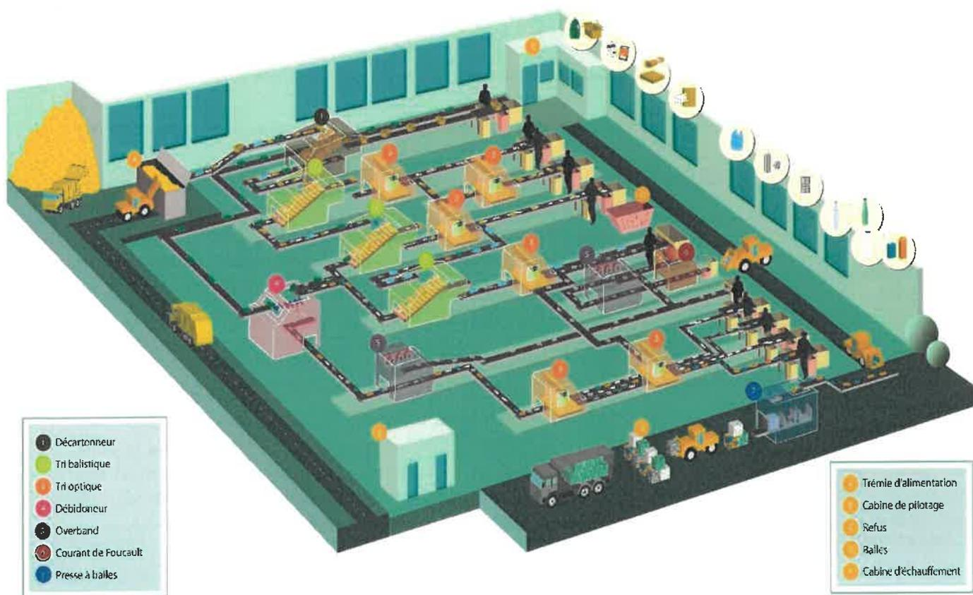
**Le hall de réception** est équipé de loges de stockage mobiles qui permettent le tri des collectes au fur et à mesure de leur arrivée (fonctionnement « FIFO first in first out » : premier entré premier sorti). Une salle fermée a été prévue afin d'effectuer les nombreuses caractérisations dans de bonnes conditions. Elle est équipée d'un tapis linéaire avec alimentation à l'extérieur et d'une bascule pour peser toutes les matières.
